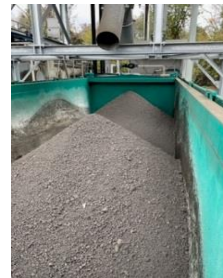
Fanghi essiccati 2.050 kg - 75 % s.s. PCI: 14.500 kJ/kg
