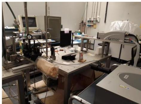
Configurazione del prototipo da laboratorio basata sull'analisi di aerosol di metalli generato tramite un nebulizzatore
