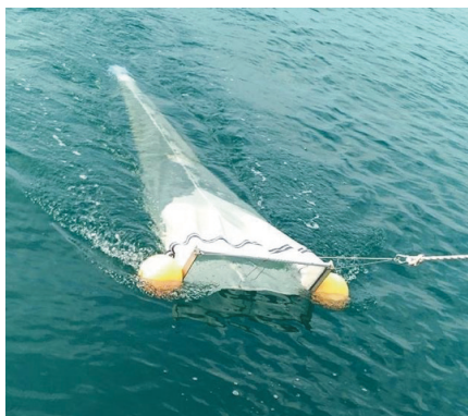
Fig. 3.5 - Retino di tipo Manta durante il suo utilizzo (foto per gentile concessione di Sathicq María Belén, Istituto di Ricerca sulle Acque - CNR).
